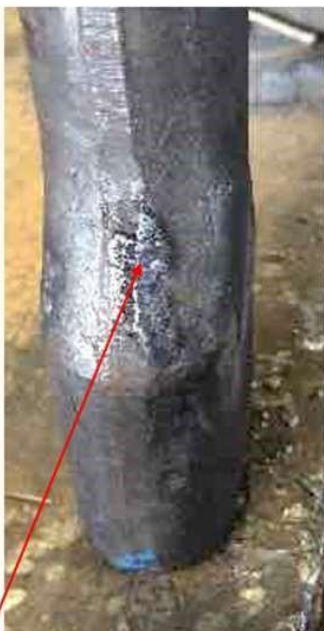
REBARBAS DE FORJA EN MATRIZ ABIERTA GENERA ALTAS PERDIDAS DE PRETENSION POR RELAJACION
